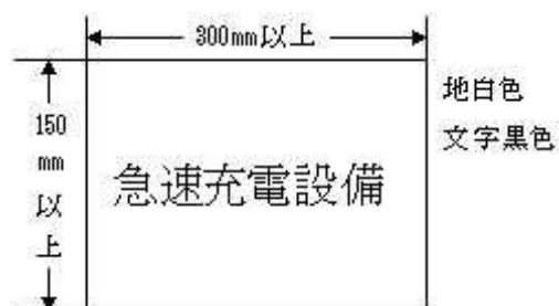
蓄電池設備の標識
